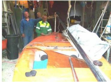
Eric s'est chargé de poser une trappe sur le caisson arrière, de renforcer le tableau arrière avec une vieille dérive d'optimist, de détordre et refixer les fémelots. Il a également assemblé la barre, le safran et le stick avant de commencer à auditer les sangles de rappel.
