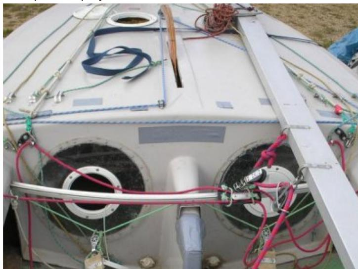
**Le caisson avant terminé.** On voit la trappe de visite supplémentaire et le remplacement des bassines par une solution beaucoup plus fiable. Remarquez en dessous du nable tribord la sortie de la vidange du pied de mât. Tous les bouts de réglages passent désormais sur le pont, donc tous les anciens trous sont à boucher.
