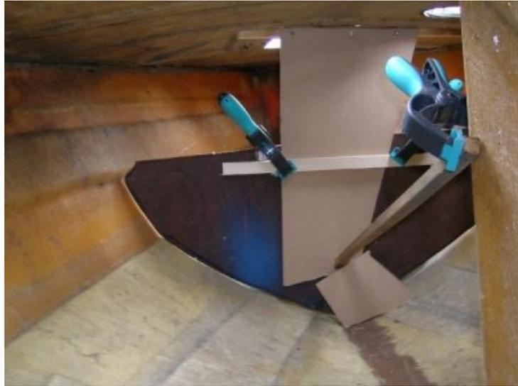
**Mise en place de la cloison** Une belle photo vaut mieux qu'un long discours.
