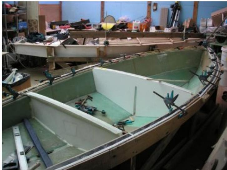
**Vue de la coque dans son moule.** Après démoulage, retour dans son moule pour la pose des cloisons du cockpit.
